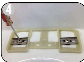
Positionnez les boulons dans leurs caoutchoucs respectifs et commencez par serrer doucement en vous assurant que la platine de fixation reste bien centrée. Ne pas bloquer les boulons
