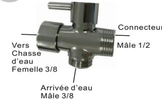
Reliez ce robinet à l'arrivée d'eau et au réservoir de la chasse d'eau selon le schéma ci-dessus (sauter cette étape si robinet mural)
