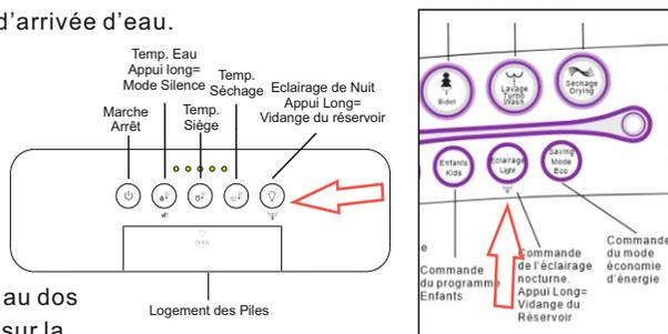
3. Sans que personne ne soit assis sur le siège, appuyez longuement sur la touche « éclairage de nuit » se trouvant au dos de la télécommande du Silver et sur la platine latérale du Bronze afin de provoquer la vidange du réservoir tampon.
