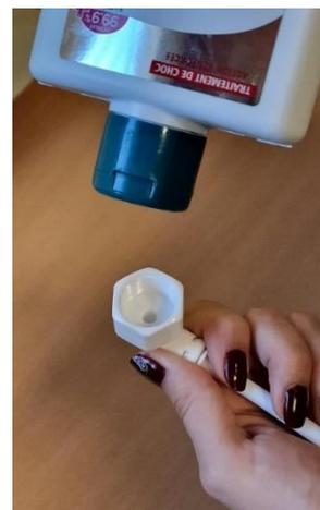
4. Videz entièrement le tuyau de son eau résiduelle puis remplissez celui-ci, en maintenant le connecteur en hauteur, au maximum de produit anticalcaire liquide, environ 40ml (type Sanytol).
