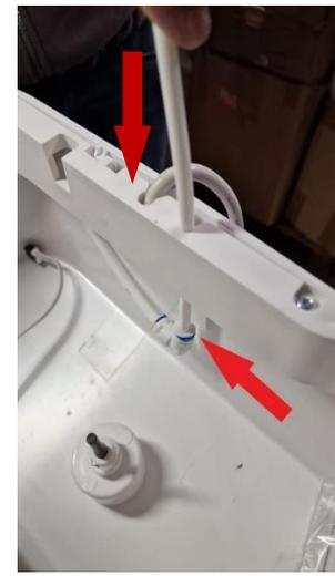
Il convient tout d'abord de pousser le tuyau blanc vers l'intérieur de l'abattant pour que le coude devienne accessible, de retirer la bague bleue de verrouillage puis d'appuyer sur la collerette blanche du coude, contre le coude et bien à plat, pour pouvoir retirer le tuyau.
